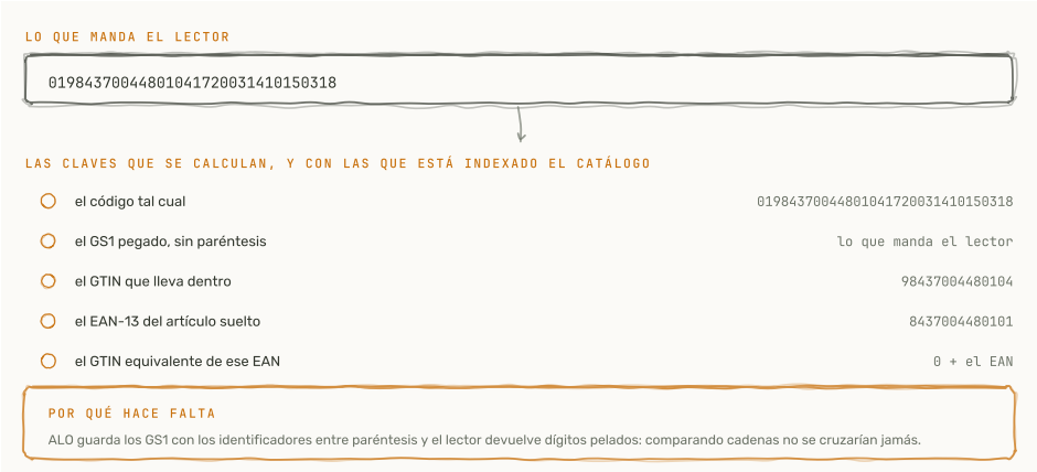
Figura A4.2 El catálogo se indexa con esas mismas claves: por construcción, se cruzan.
